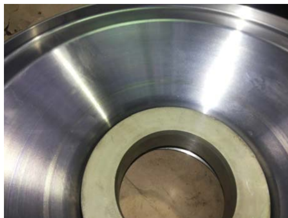
Рис. 5. Дефектация корпуса сопла РДТТ, корпус до ГРИ
