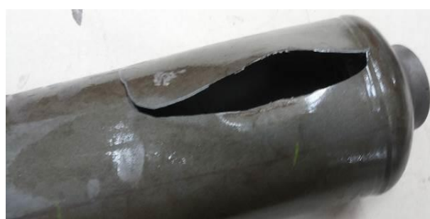
Рис. 1. Корпус РДТТ после ГРИ
