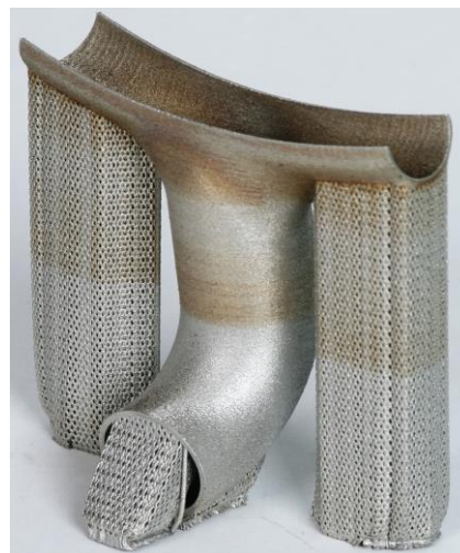
Рис. 1. Патрубок для камеры двигателя РД861К после печати (с суппортами)
