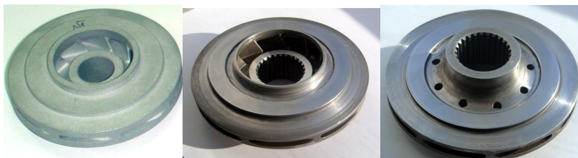
Рис. 5. Крыльчатка насоса после 3D-печати (слева) и окончательно изготовленная (после мехобработки и хромирования уплотнительных буртов)
