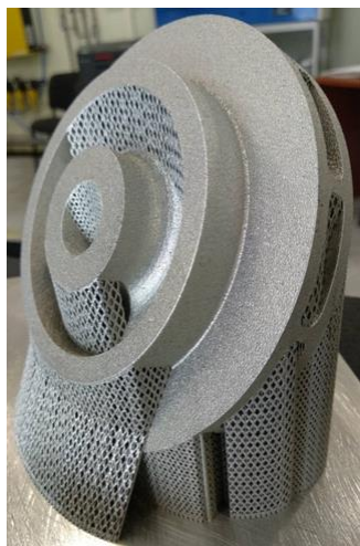
Рис. 8. Крыльчатка центробежного насоса с суппортами на плите построения
