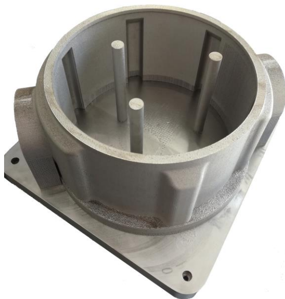
Рис. 7. Корпус теплообменника гелия двигателя РД815 на плате построения с образцами-свидетелями
