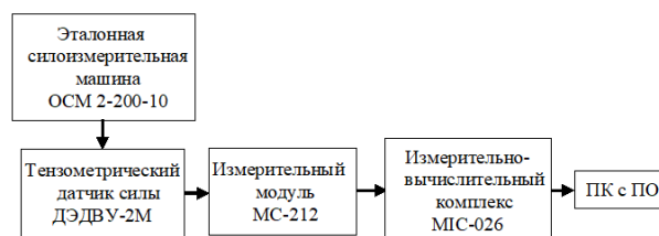
Рис. 2. Структурная схема экспериментальных исследований ИК R_{x1}
