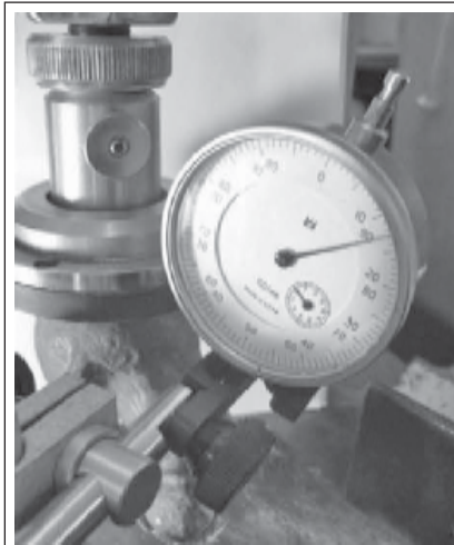
Рис. 3. Вимірювання зміщення проксимального відламка за допомогою механічного індикатора годинникового типу
