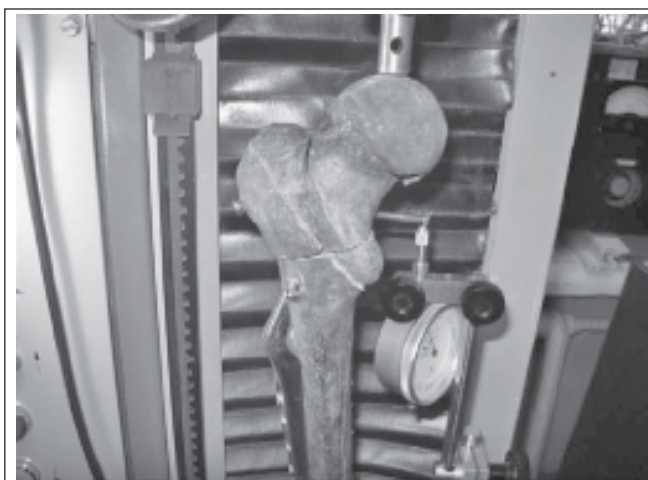
Рис. 5. Дослідження жорсткості фіксації при осьових навантаженнях
