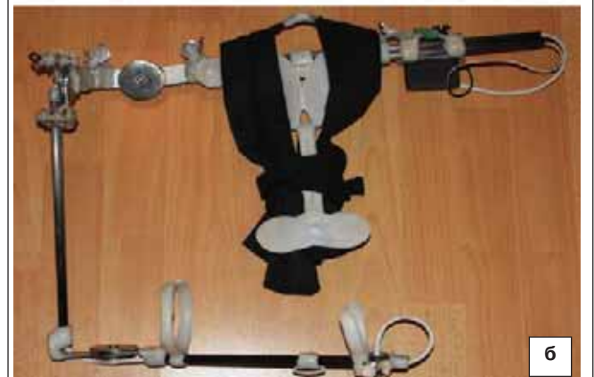
Рис. 1. Примеры реализации шин для реабилитации: а) Механическая шина для реабилитации «МЕТОДИСТ» б) Пример реализации автоматизированной шины
