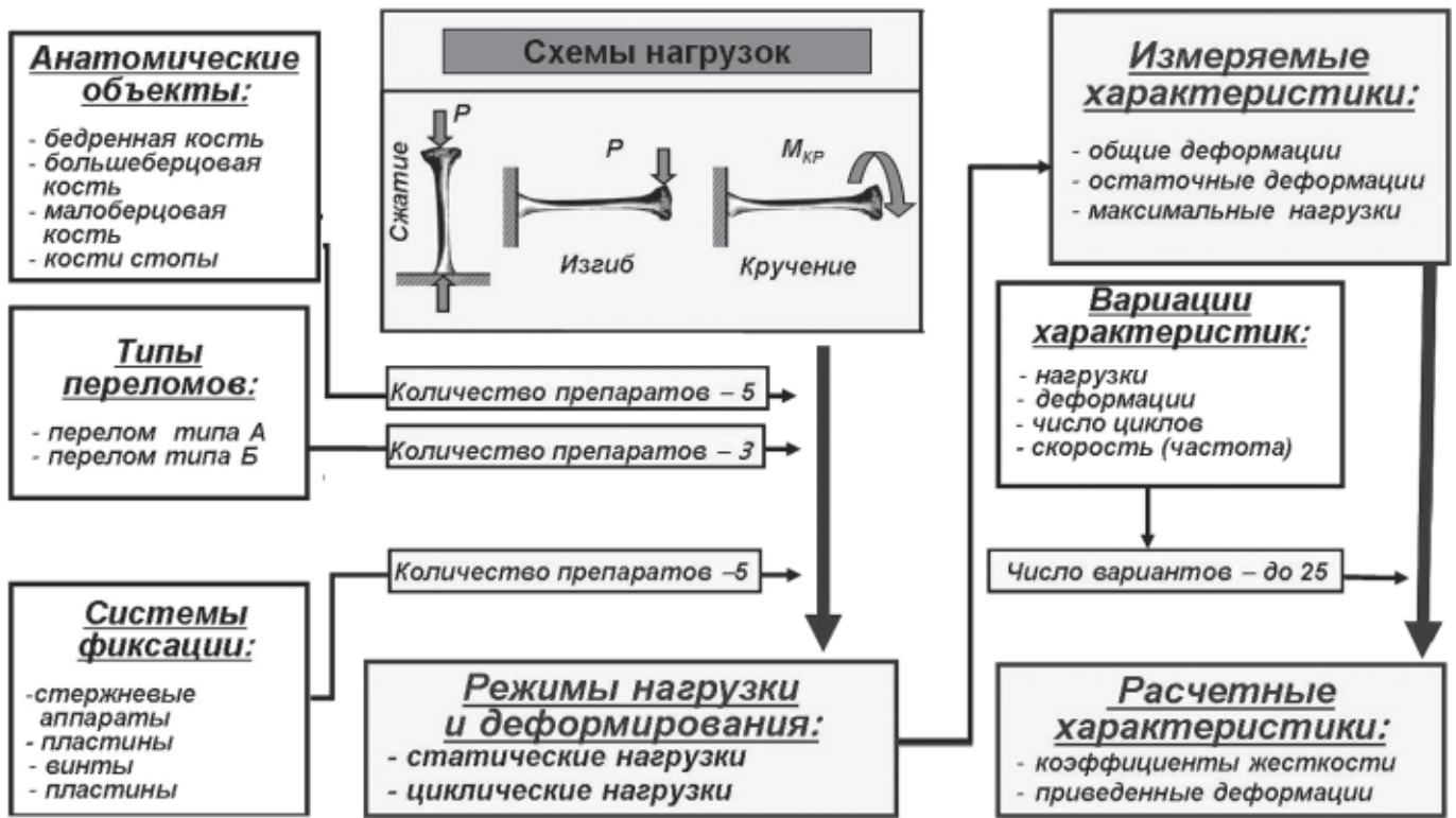
Рис. 3. Блок-схема комплексных исследований деформационной надежности систем остеосинтеза с учетом статических и циклических нагрузок
