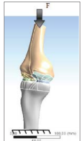
Рис. 4. Тривимірний твердотільний біомеханічний модель коліного суглоба (ANSYS) під дією сили навантаження F
