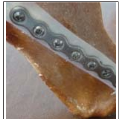
Рис. 1. Визначення тиску на поверхні контакту пластина-кістка з використанням вимірювальних плівок Fuji Prescale
