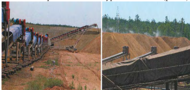
Рис. 5. Барабанный окомкователь ОБР 2,5x9 в технологической линии кучного выщелачивания золота предприятия «Покровский рудник» УК Петропавловск
