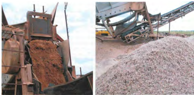
Рис. 4. Исходные и переработанные в скруббер-бутаре СБР-100, отмытые и расклассифицированные продукты
