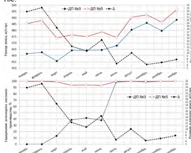
Рис. 5. Фактический расход кокса и содержание агломерата местного производства на ДП № 3 и ДП № 5 ПАО «ЕМЗ» за 2012 г.
