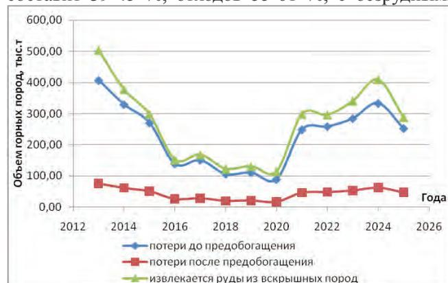
Рис. 4. Снижение потерь руды после предобогащения
