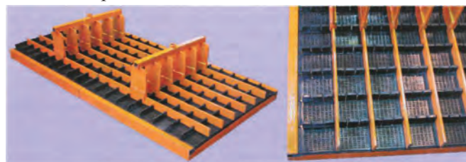
Рис. 3. Общий вид и фрагмент решета отсадочной машины МОД-2(3; 4) на основе просеивающих элементов типа СДАЛ с ячейками 2,5x10,0 мм элементов типа СДАЛ
