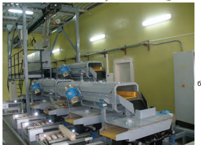
Рис. 1. Установка дробления и отсева поликристаллического кремния: а – общий вид установки; б – промышленный вариант установки в цехе ПАО «Завод полупроводников»
