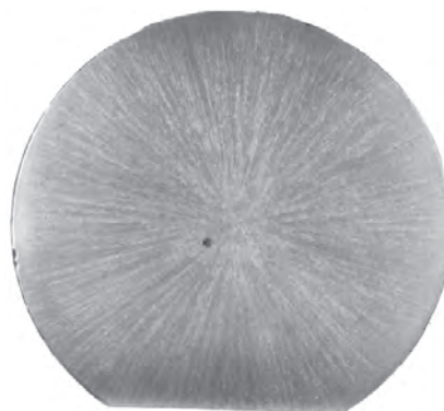
Рис. 2. Макроструктура бочки прокатного валка из чугуна с шаровидной формой графита Ø 450 мм (в осевой зоне виден след горячего спая термопары) [7]
