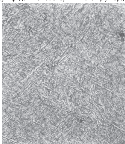
Рис. 2. Структура «интрагранулярного» игольчатого феррита в конструкционной стали микролегированной нитридообразующими элементами после термической обработки, x 800
