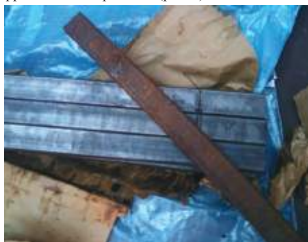
Рис. 1. Вид неупакованных и защищенных антикоррозионной упаковкой труб после 2,5 мес. экспозиции в натуральных условиях
