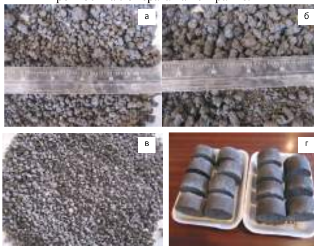
Рисунок. Фотографии гранул, полученных: а – окатыживанием; б – экструзией; в – дроблением брикетов (брикетное крошево); г – исходные брикеты
