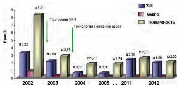
Рис. 4. Динамика отбраковки титанистых коррозионностойких сталей в прокатном цехе по дефектам сталеплавильного производства
