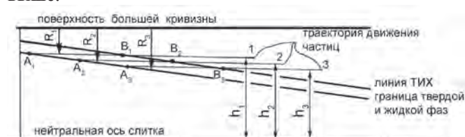
Рис. 5. Схема, поясняющая нелегитимность суммирования деформации вдоль линии (слоя) ТИХ
