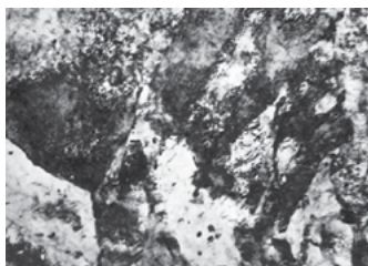
Рис. 2. Микроструктура поверхностного слоя термически упрочненной арматуры Ø 22 мм, Ст3 после повторного нагрева до 350 °С, ×18000
