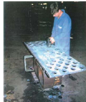
Рис. 3. Восстановление рабочей поверхности сита грохота
