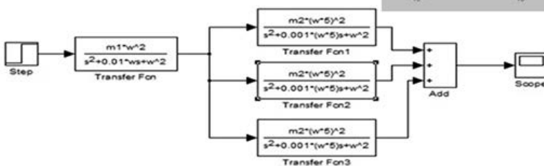
Рис. 1. Структурная схема модели шламового насоса
