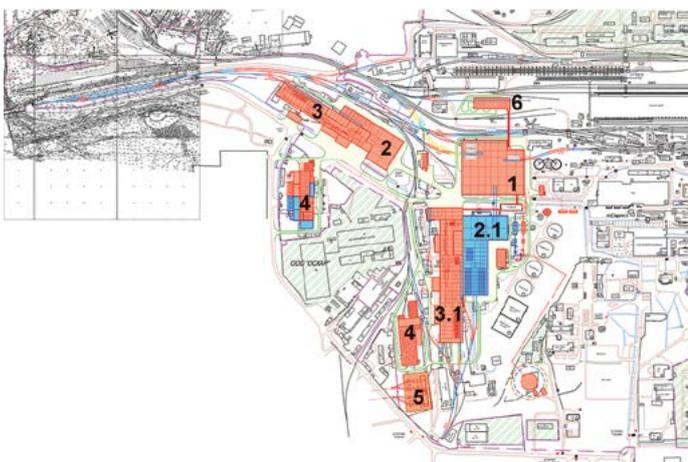
**Рис. 4. Литейно-прокатный комплекс ООО «Тулачермет-Сталь» (1 вар.):** 1 – ККЦ; 2 – Участок ОНРС (сортовая МНЛЗ); 2.1 – Участок ОНРС (слябовая МНЛЗ); 3 – СПЦ (мелкосортный прокатный стан); 3.1 – СПЦ (среднесортный прокатный стан); 4 – Водоподготовка; 5 – Электроподстанция; 6 – Участок подготовки материалов
