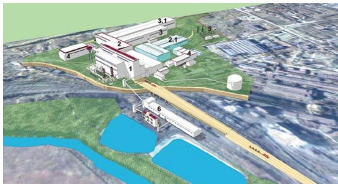
**Рис. 6. Литейно-прокатный комплекс ООО «Тулачермет-Сталь» (2 вар.):** 1 – ККЦ; 2 – Участок ОНРС (сортовая МНЛЗ); 2.1 – Участок ОНРС (слябовая МНЛЗ); 3 – СПЦ (мелкосортный прокатный стан); 3.1 – СПЦ (среднесортный прокатный стан); 4 – Водоподготовка; 5 – Электроподстанция; 6 – Участок подготовки материалов
