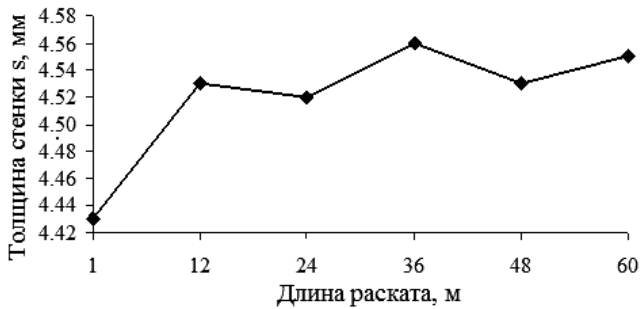
Рис. 2. Характер изменения толщины стенки по длине раската готового профиля двутавровой балки № 14
