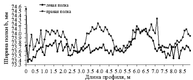
Рис. 5. Колебания ширины полок двутавровой балки № 14 (раскат длиной 9 м, шаг измерения 100 мм)
