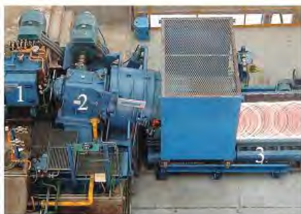
Рис. 1. Участок образования и укладки витков на роликовый транспортер (а), вид сбоку на процесс укладки витков (б)
