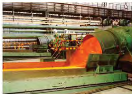
Рис. 1. Участок образования и укладки витков на роликовый транспортер (а), вид сбоку на процесс укладки витков (б)
