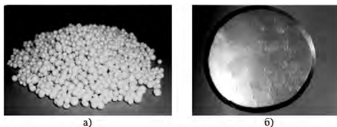
Рис. 1. Внешний вид ПВВ (а); разрез гранулы аммопора-В (б), \times 120
