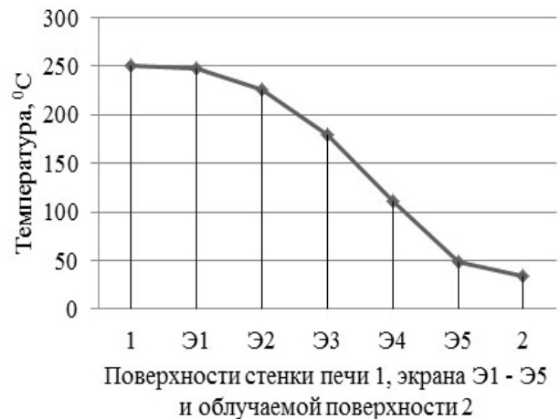
Рис. 2. Распределение температур в тонкостенном многослойном экране
