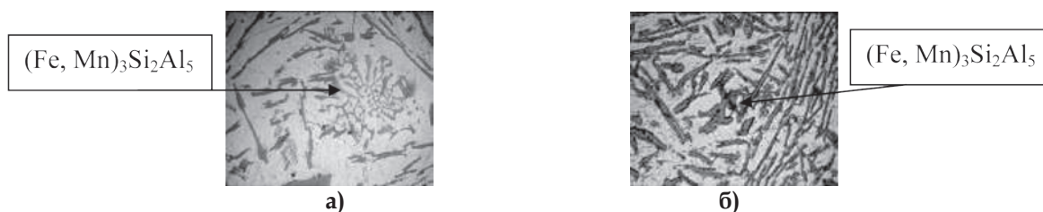
Рис. 2. Структура исходного модифицированного силумина АК18, х400: а - V_{\text{охл}} = 0,04 \text{ } ^\circ\text{C}/\text{мин} ; б - V_{\text{охл}} = 0,4 \text{ } ^\circ\text{C}/\text{мин}
