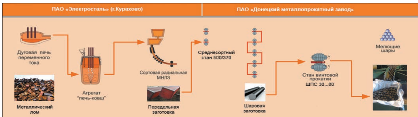
Рис. 2. Интегрированная технологическая схема производства МШ: ПАО «Электросталь» (г. Курахово) – ПАО «Донецкий металлопрокатный завод»
