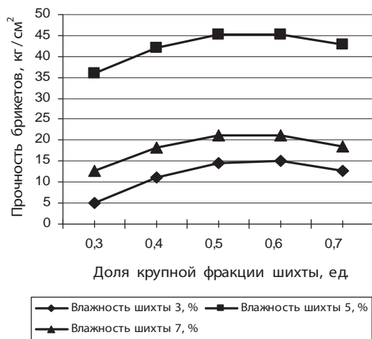
Рис. 2. Изменение прочности брикетов в зависимости от доли крупной фракции шихты при различной влажности
