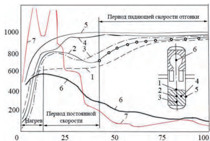
Рис. 2. Изменение температуры (1-6) и давления (7) в ходе процесса в промышленном аппарате вакуумной сепарации цикловой производительностью 4,5 т
