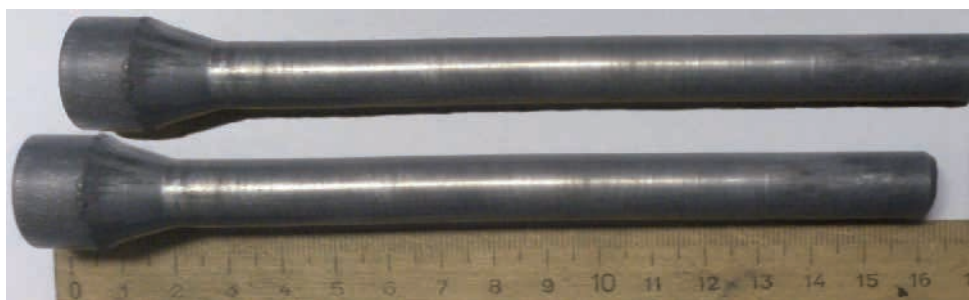
Рис. 5. Ствольные заготовки, полученные путём гидроэкструзии на гладкой оправке
