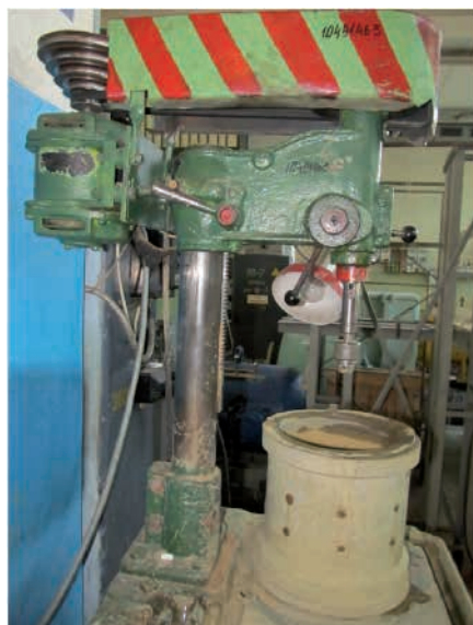
Рис. 1. Лабораторная установка исследования абразивного износа
