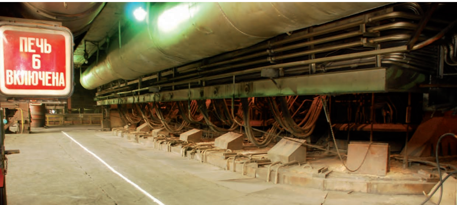
Ферросплавная руднотермическая электропечь РПЗ-63И1
