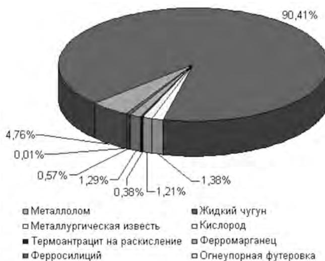
Рис. 1. Структура энергоемкости конвертерной стали
