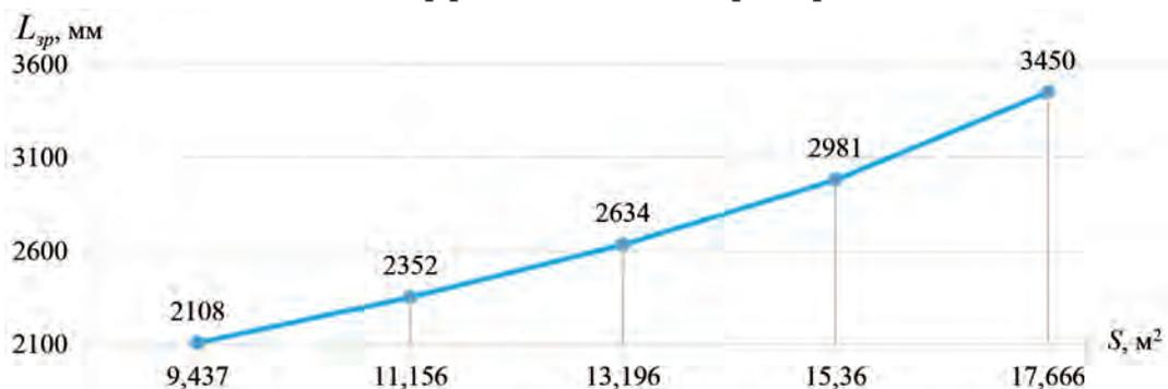
Рис. 4. Графики зависимости протяженности зоны неравнокомпонентного напряженного состояния от площади сечения
