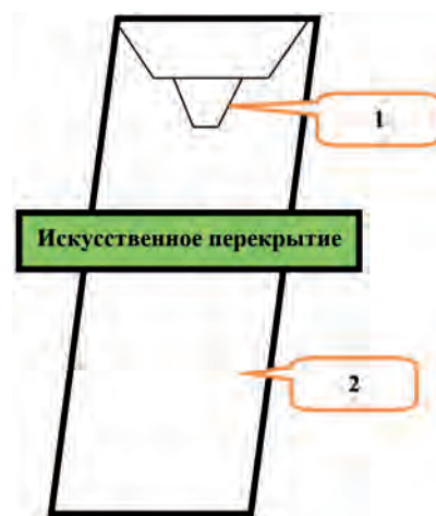
Рис. 1. Схема размещения искусственного перекрытия для разделения открытых (1) и подземных (2) горных работ
