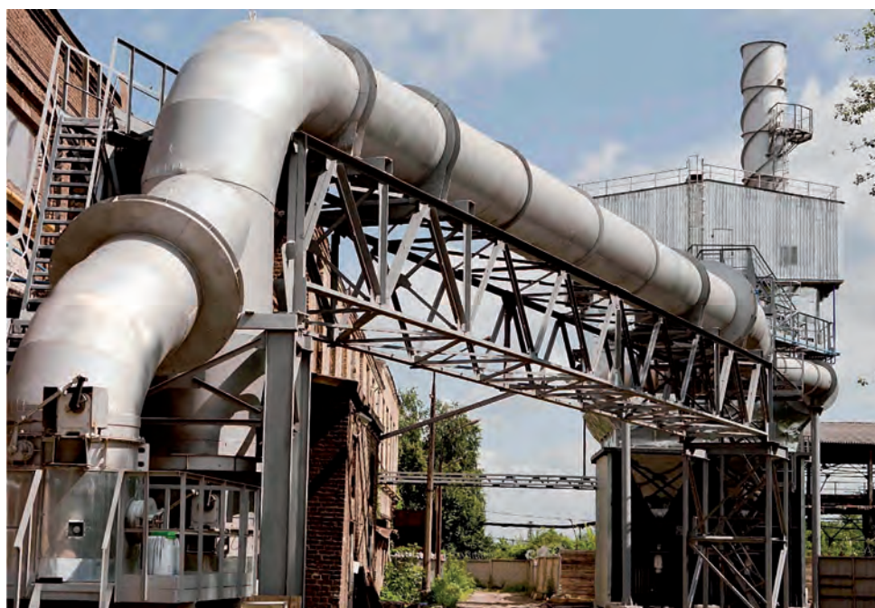
Рис. 3. Двухмодульный рукавный фильтр с импульсной регенерацией ФРИР-1100x2
