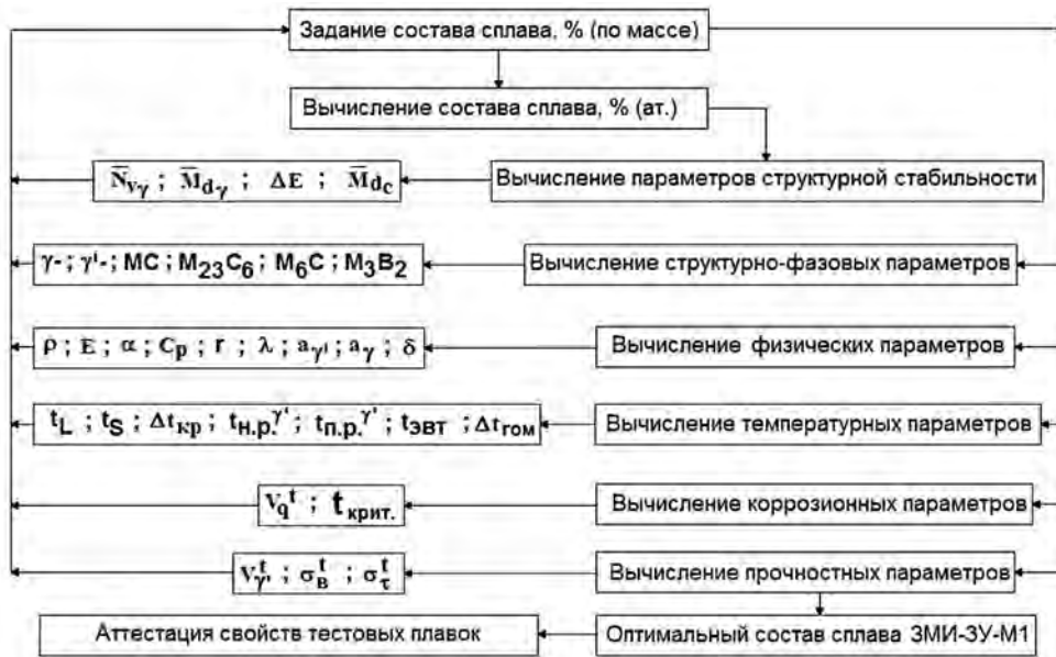
Рис. 1. Алгоритм компьютерного расчета проектируемого сплава ЗМИ-3У-М1 по разработанной методике КРАМ [2-4]
