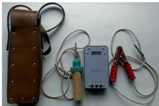
Рис. 2. Комплект экспериментального образца виброакустического индикатора КВАК-1
