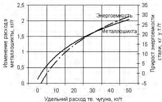
Рис. 10. Номограмма влияния расхода твердого чугуна на изменение расхода металлошихты и энергоёмкости стали
