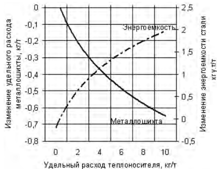
Рис. 5. Номограмма для определения влияния расхода угля на изменение удельного расхода металлошихты и энергоёмкости стали
