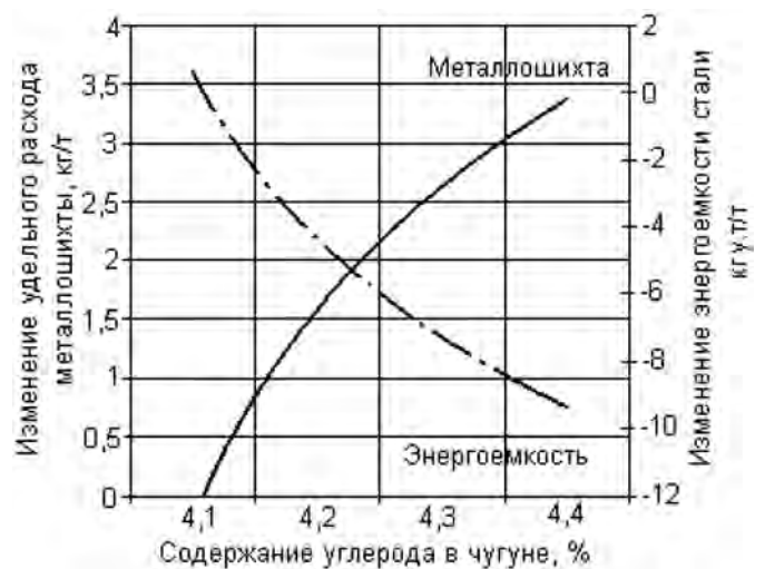
Рис. 7. Номограмма для определения влияния содержания углерода в чугунах на изменение удельного расхода металлошихты и энергоёмкости стали
