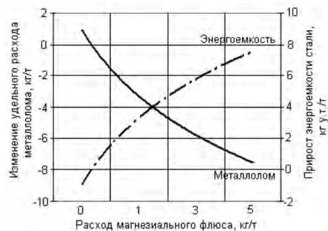
Рис. 14. Номограмма для определения влияния расхода магнезитового флюса на изменение удельного расхода металлолома и энергоёмкости стали
