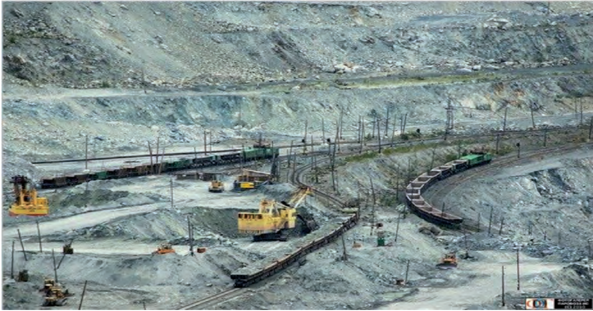
Рис. 7. Перегрузочная площадка с двусторонним подъездом железнодорожного транспорта
