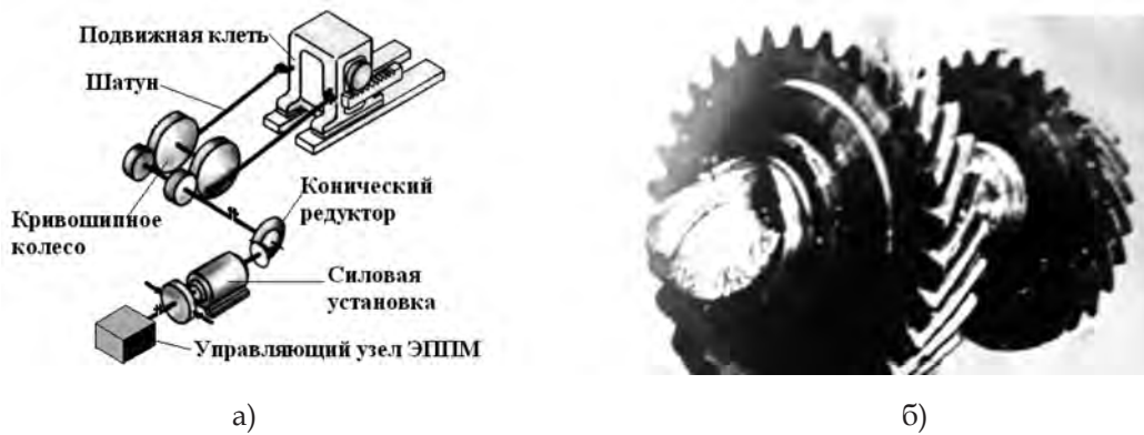
Рис. 1. Главный привод стана ХПТ (а) и разрушенный узел приводного вала (б)
