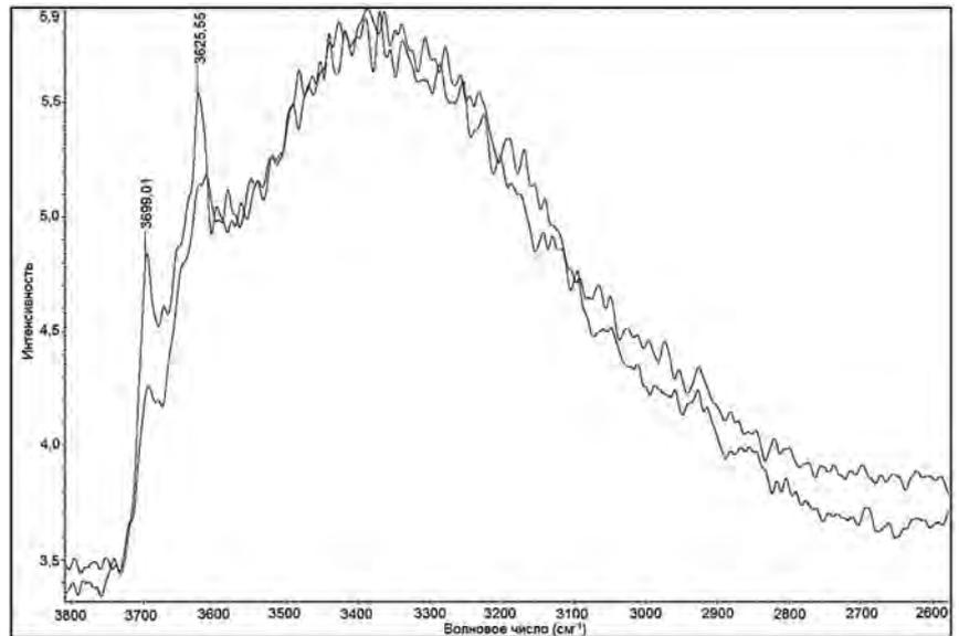
**Рис. 4. ИК-спектры поглощения электромагнитного излучения щелочного алюмосиликата пегматитом в интервале волновых чисел  $2600\text{--}3800\text{ см}^{-1}$**
