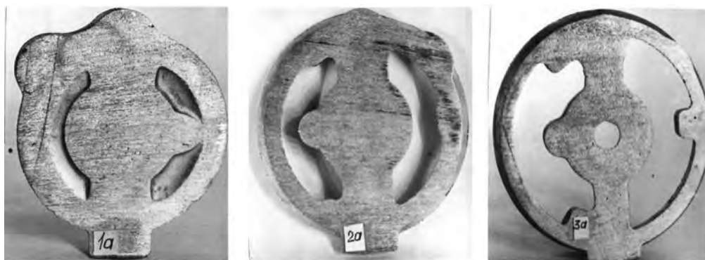
Рис. 5. Сечение отливки при центральном подводе металла: 1а – 30 мм от нижнего торца отливки; 2а – 45 мм от нижнего торца отливки; 3а – 60 мм от нижнего торца отливки
