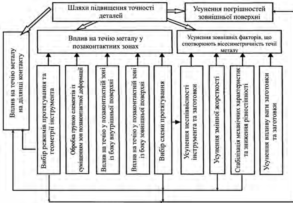
Рис. 14. Технологічні варіанти управління точністю деталей, оброблених деформуючим протягуванням
