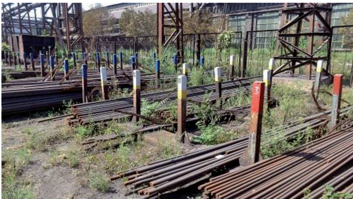
Рис. 1. Загальний вигляд сортування заготовок за марками сталі на ковальській дільниці ПАТ «ДМК» [16]
