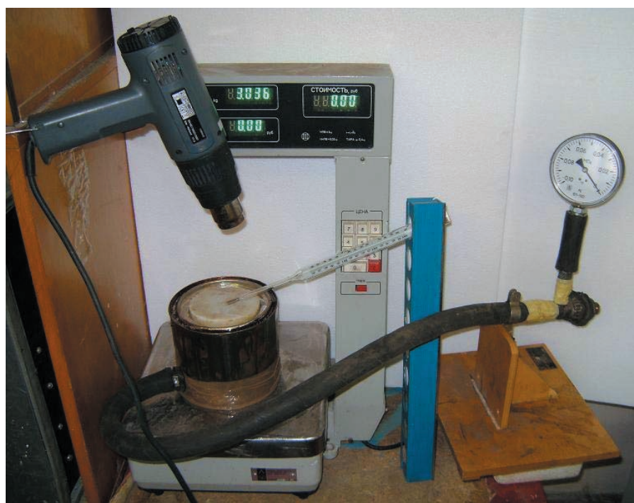
Рис. 1. Установка для взвешивания вакуумируемой формы при таянии ледяной модели
