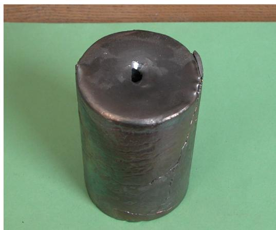
Рис. 2. Внешний вид слитка после плазменно-дуговой выплавки
