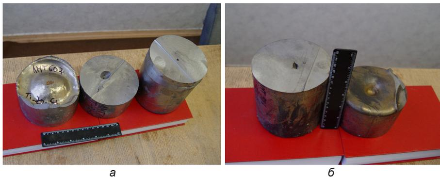
Рис. 1. Внешний вид слитков после ЭЛП и механической разрезки
